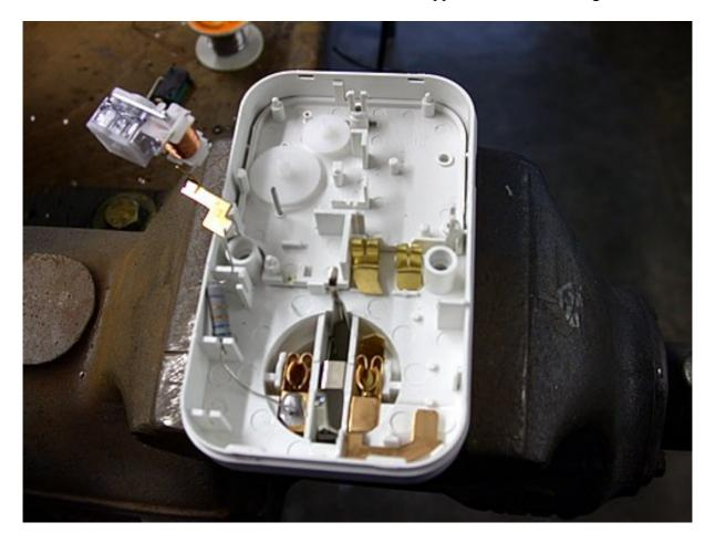
Sie werden durch Drähte (0,75,mm2) ersetzt und über Kreuz verlötet:
