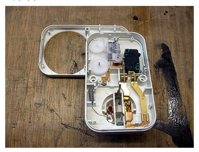
Die breiten Messingstreifen lassen sehr gut die Strompfade erkennen. Der linke kommt vom L1/N, der in der Steckdose steckt, der rechte geht zur Last. An dem linken hängt auch der Motor. Man muß also nur die beiden vertauschen, schon hat man die "Monostabile Zeitschaltuhr mit variabler Verweilzeit…"
